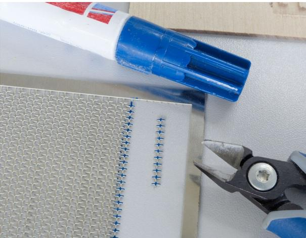
Mit dem Seitenschneider werden die Nägel getrennt
