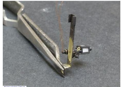
2 - Auf der Unterseite des Laternenträgers wird ein kleines 0,3mm Blech gelötet oder geklebt.
