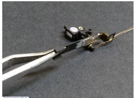
3 – Eine der beiden beiliegenden Nieten in das unterste, gesäuberte Loch des Hebels stecken und verlöten oder verkleben.
