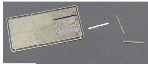
Schritt 3: die zweite Querstrebe anlöten, dabei nach dem Anheften die Position mit Hilfe des Rundstabs (in die Vertiefungen einlegen) die Position überprüfen
