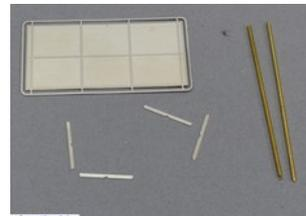
Schritt 2: eine Querstrebe und das Feld verzinnen und die Strebe rechtwinklig in die Mitte des oberen Feldes einlöten (auch Kleben mit Sekundenkleber ist möglich!)
